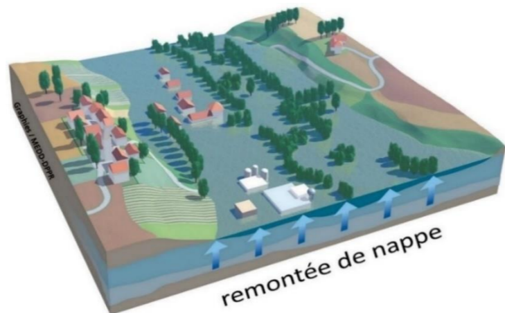
Figure 10 : Le phénomène d'inondation (Source : georisques.gouv.fr)
